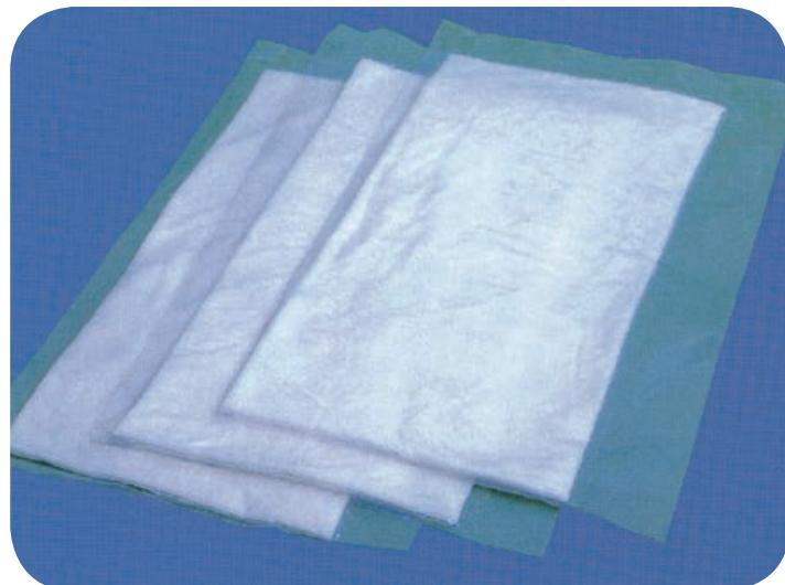
Superwool® Plus ウェットフェルトはSuperwool® Plus ブランケットに無機バインダーを含浸させた製品で、ウェット状態でポリ袋にパックしてあります。優れた断熱効果に加え、耐風速性、耐摩耗性が要求される所への施工に適しています。
